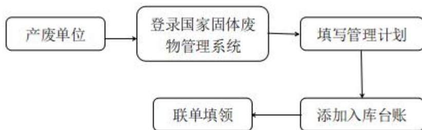
图 2-7 危险废物市内转移流程图
