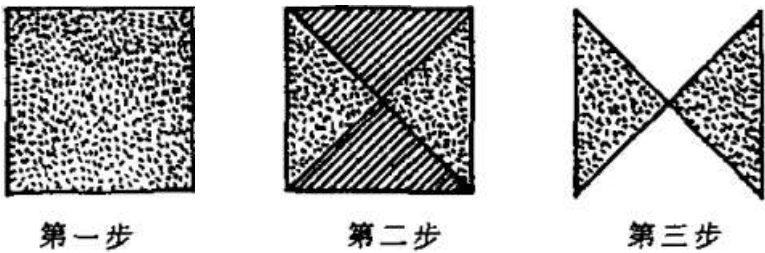
图 2 方形四分法取样示意图
